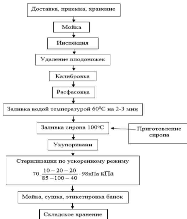
Рисунок 3 – Инновационная технология производства компота из черешни в стеклбанке объемом 0,5 л с использованием предварительного нагрева плодов в банках горячей водой
