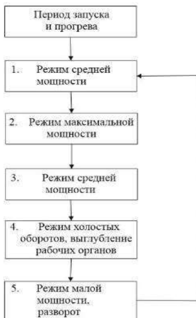
Рисунок 2 – Структурная схема последовательности расчетных режимов движения трактора на с/х работах
