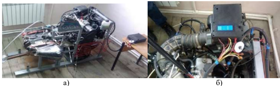
Рисунок 1 – Установка: а) экспериментальный стенд; б) прибор ДБД-4 для тестового диагностирования
