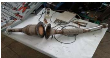
Рисунок 2 – Разъемная конструкция каталитического нейтрализатора для удобного формирования его промежуточных технических состояний
