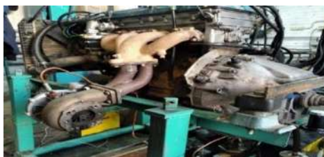
Рисунок 2 – Экспериментальный стенд на базе ДВС 3МЗ-4062 с системой турбокомпрессорного наддува
