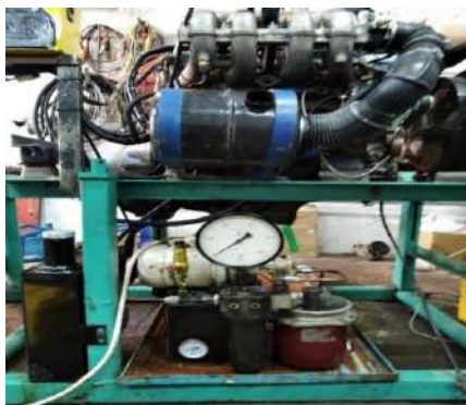
Рисунок 5 – Маслостанция, установленная под экспериментальным стендом
