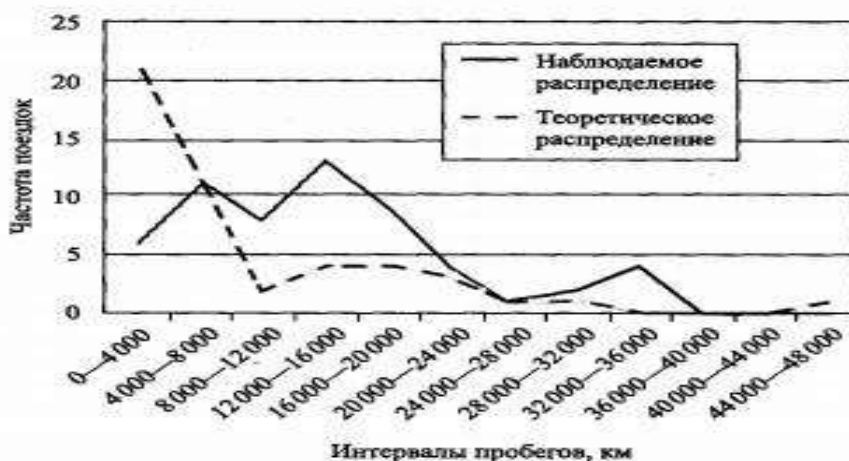
Рисунок 1 - Графики экспериментального и теоретического распределения пробегов автобусов Volgabus-5270Н до сходов с маршрута по неисправности сцепления
