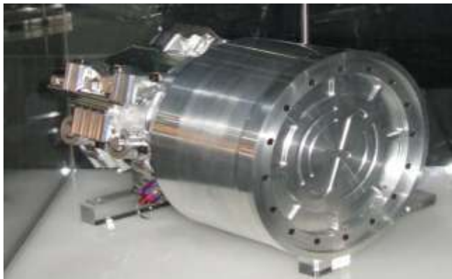
Рисунок 3 - Маховиковая система KERS.
