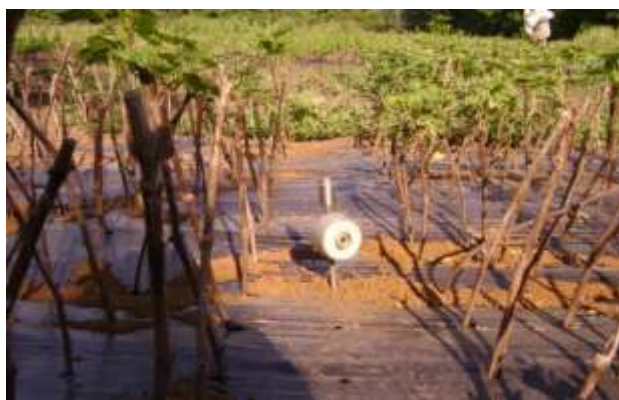
Рисунок 1 - Тензиометр, установленный на глубину 30 см на виноградной школке
