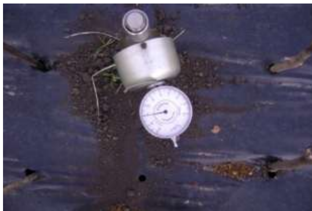
Рисунок 2 - Измерение водоудерживающей силы почвы, съемным индикатором тензиометра
