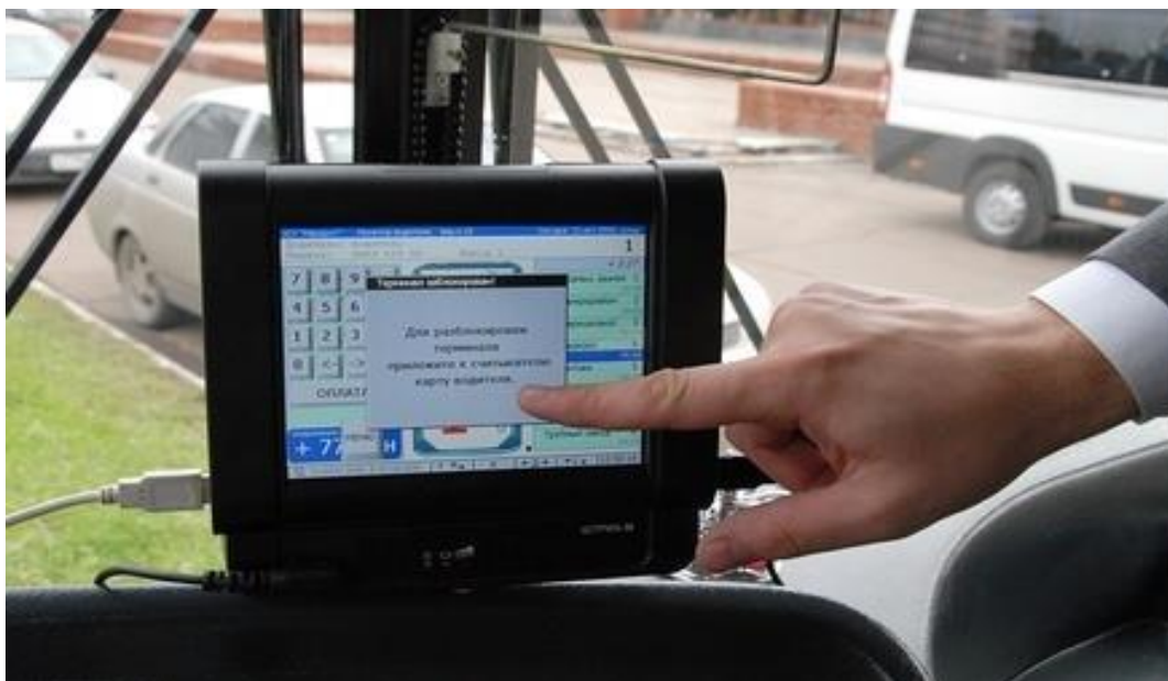
Рисунок 1 - Вид панели навигатора системы ГЛОНАСС, установленного в автобусе
